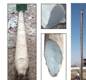
掘り起こしたピュアパイル。地中でこのような状態になり、強固に地盤を補強します。
