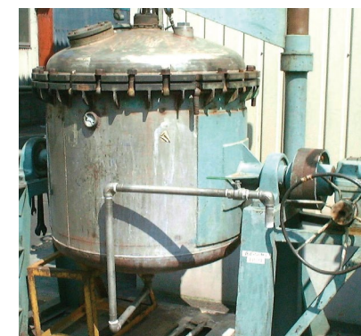
ヌッチェ式フィルター [直径]1300φ [濾過面積]0.8m 2
