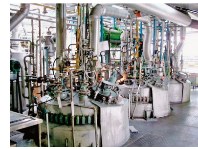
SUSタンク 300L×1台 / 1500L×1台 / 2000L×2台 / 4000L×1台 [モータ]22~11kW [耐圧]常圧~50Toor [加温]スチーム
