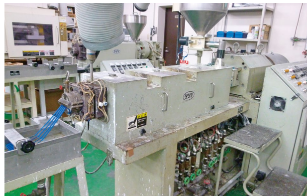
40mm二軸押出機(L/D=30)
