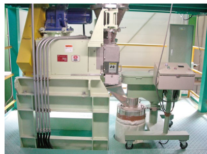
造粒 (圧迫) ⑩ローラーコンパ クター [生産量]~500kg/D×3台
