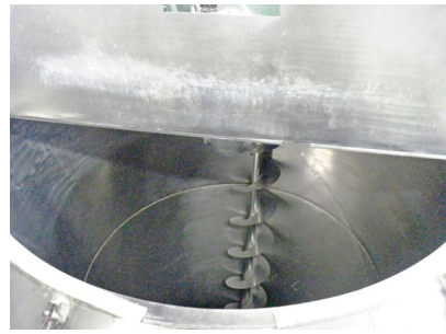
混合 ①ナウターミキサー [容量]2000L×1台 3500L×1台
