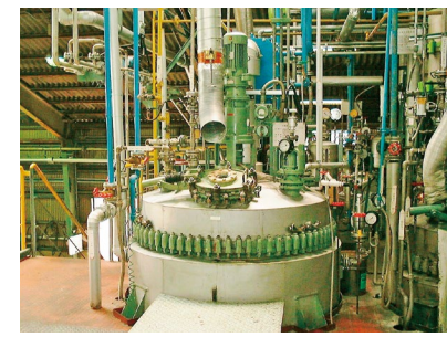
GLタンク 300L×1台 / 1500L×4台 / 2000L×1台 / 3000L×4台 [モータ]37kW [耐圧]常圧~40Toor [加温]スチーム
