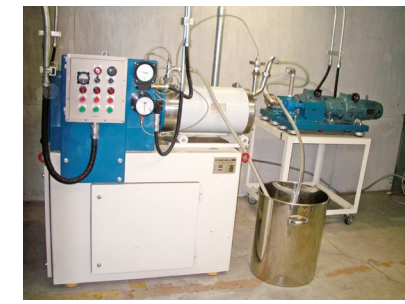
ダイノミル [モータ]18.5~22kW [容量]16.5L [ビーズ]①シリコニア ②チタニア
