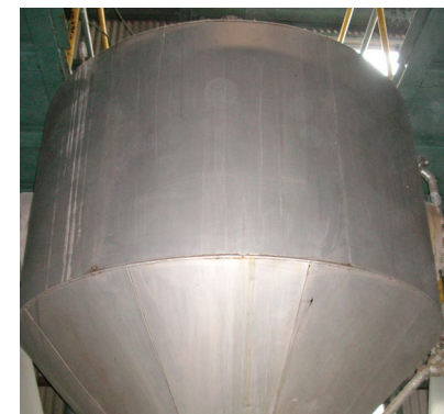
コニカルドライヤー 加熱減圧乾燥器 [外部熱交換]10m 2 [受器]800L [容量]2000L
