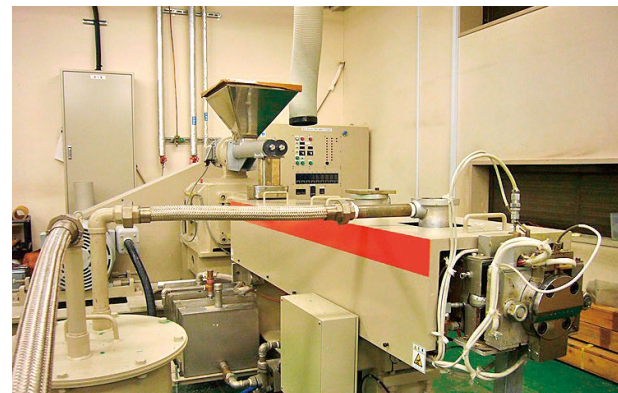
46mm二軸押出機(L/D=40)
