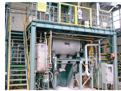
真空攪拌乾燥機(VDR) [外部熱交換]30m 2 [受器]500L [容量]1000L
